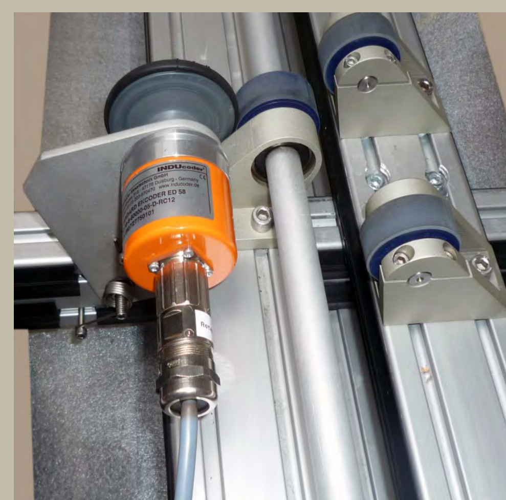
Abb. 3: Antriebswelle mit Wegaufnehmer für die Scanachse
